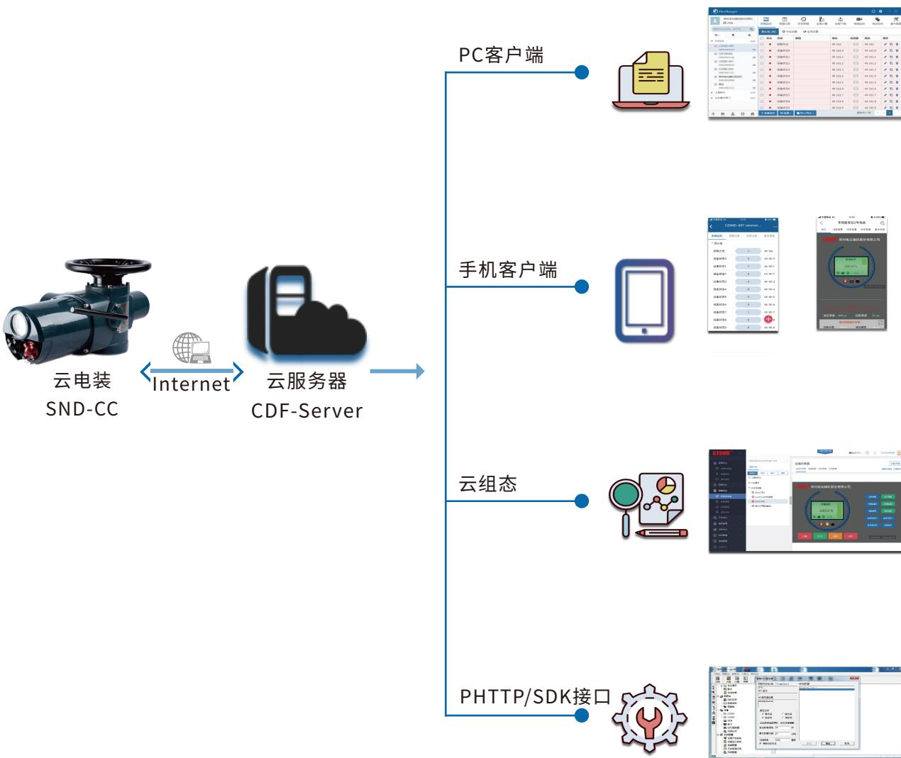
用于连接现场的SND系列云电装，实现设备的连接管理、数据采集、存储和传送等功能，是现场设备与用户应用端相连接的桥梁。
